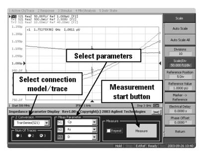
Figure 7. Impedance parameter display software
